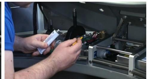
Il grasso fluorato SP 240 è stato omologato dalla società SPII per la lubrificazione dei banchi integrati e dei sezionatori da tetto del nuovo treno Alta Velocità ETR 1000
